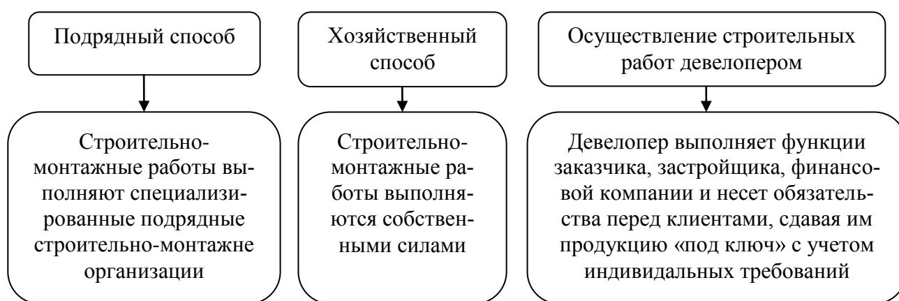
Рисунок 2.2 - Способы выполнения строительных работ
